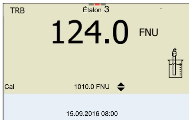
16. Appuyer sur <M> pour mettre fin à la calibration comme calibration deux points. Les nouvelles valeurs de calibration s'affichent. ou Continuer avec la calibration 3 points.
